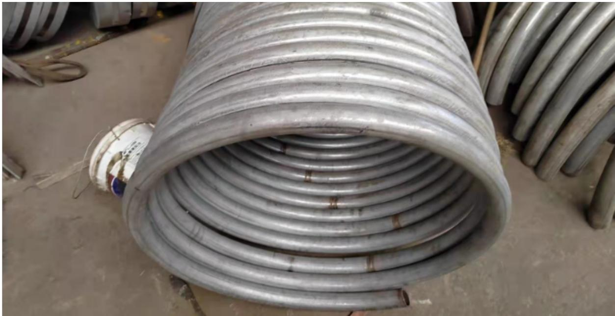
在制作半圆管的过程中，防生锈是一个非常重要的环境。如果防生锈的工作没有做到位的话，那么后期往往会影响半圆管的使用情况。所以我们还是需要在制作半圆管的过程中，做好相对应的防锈工艺。首先我们一定要从原材料的质量抓起，也就是说，在进行制作半圆管之前，我们要保障所用原材料的质量是符合半圆管工艺加工要求。并且还要将其表面所存在的不同污物给清理干净。对于半圆管表面的处理，小编在此给各位提出三点比较好用的方法哦！1. 乳化处理：使用乳化和溶剂对半圆管表面清洗作为腐蚀制作的辅助方法，因为它不能除去管材表面的氧化皮，通量和生锈，但它可以清洗刚，表面去除油脂，一类有机化合物，润滑油和灰尘。2. 喷射除锈处理：喷射除锈不但能清理半圆管表面的氧化物，铁锈，和磨料和钢管的摩擦和撞击力也能达到所要求的表面粗糙度均匀的使用。3. 除锈处理：生锈钢铁表面倾斜，规模和焊渣，除渣方法可用于清洁的工具，即磨钢丝刷工具的表面。但如果钢表面的氧化皮，盖固定，除锈效果并不理想，因为动力工具清理可以达到3级手动工具除锈，因此选择除锈方法根据实际情况。无锡日之尧科技可供应弯管 欢迎咨询。浙江不锈钢半圆盘管哪家便宜
