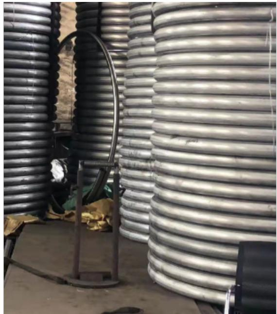
盘管就是一种呈螺旋状的管道系统的管件，一般在应用的时候，稍不注意，就会发生断裂的现象，那么我们因为怎样该控制好这一点呢？1、可以提高材料的纯净度，降低盘管材质中杂质的含量。2、提高成分设计，已经在热、冷扎退火工艺处理。3、增加盘管的拉深道次，增大凹模圆角半径，从而降低材料的变形难度。以上的几点就是，盘管在应用之时需要控制好的要点了。对于专业的人来说，不锈钢盘管是一种很多理解的钢材产品，然而对于不了解的人来说，它就什么也不是啦，那么\*\*\*小编带大家重新认识一下不锈钢盘管，想要了解不锈钢盘管，那么它虽具有的分子量是必不可少的一步。我们讲解不锈钢盘管，不仅\*是为了让大家了解这款产品的名字，而是让大家深刻的了解到不锈钢盘管所拥有的性能特点以及具体的用途，那样的话，你才会更好的应用它。关于不锈钢盘管的分子量，即较高的分子量导致较高的聚合物粘度，不过粘度也与测试所用的温度和剪切速率有关，通常我们在采用不锈钢盘管的时候，可以用流变或分子量测量，来对材料的分子量进行表征。终上所述，本期关于不锈钢盘管具有的分子量的知识，小编就暂时分享到这里了。
